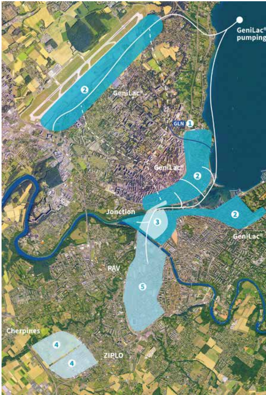
Figur 4: Det relativt småskaliga pilotprojektet i FN-kvarteren GLN (1) skalades upp till sjökyla-/värmesystemet GeniLac som värmer och kyler bebyggelse i de centrala och östra delarna av staden (2) samt i stadsdelen Jonction (3). Överskottsvärmen från industrierna i Plan-les-Ouates värmer befintlig och ny bebyggelse i Les Cherpines (4). Vid stadsomvandlingen i PAV (5) används flera olika värmekällor för uppvärmning.
