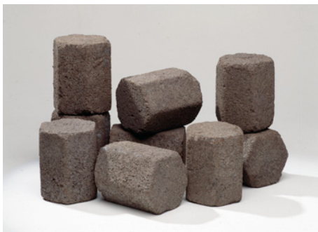
Restproduktbriketter In ca 150 kg/ton råjärn (trj) Ca 3,3 % biomassa
