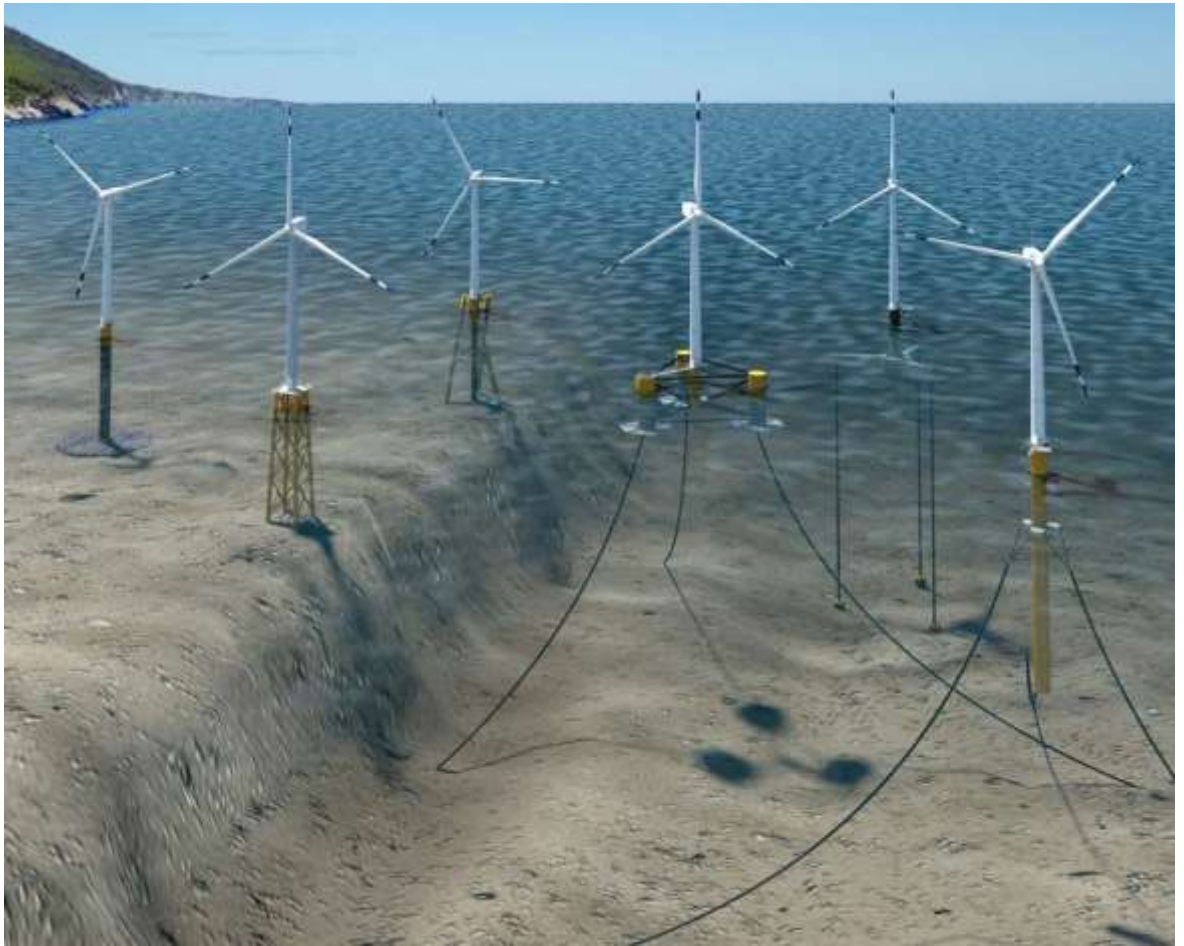
Figur 28: Fundamenttyper för olika vattendjup
