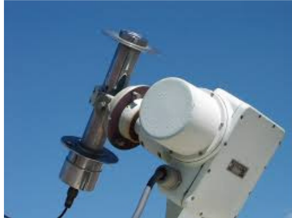
Figur 4 Pyrheliometer med automatisk solföljning
