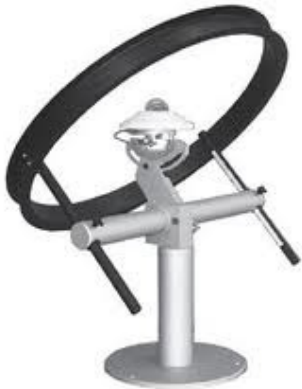
Figur 3 Pyranometer med skuggring
