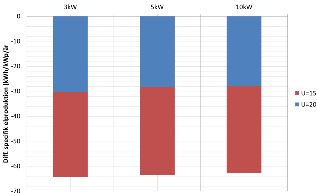
Figur 21 Minskning av specifik årlig elproduktion för olika typer av montering jämfört med basfallet, fristående system U = 29 \text{ W/m}^2/\text{K} . U = 20 \text{ W/m}^2/\text{K} representerar ett system med ventilation (självcirkulation) på baksidan av modulerna, U = 15 \text{ W/m}^2/\text{K} representerar ett integrerat system utan ventilation
