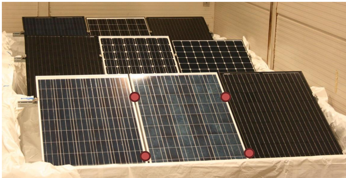
Figur 63 Modulernas montering i klimatkammare under snö- och istest (modulernas infästningspunkter är markerade med röda cirklar)
