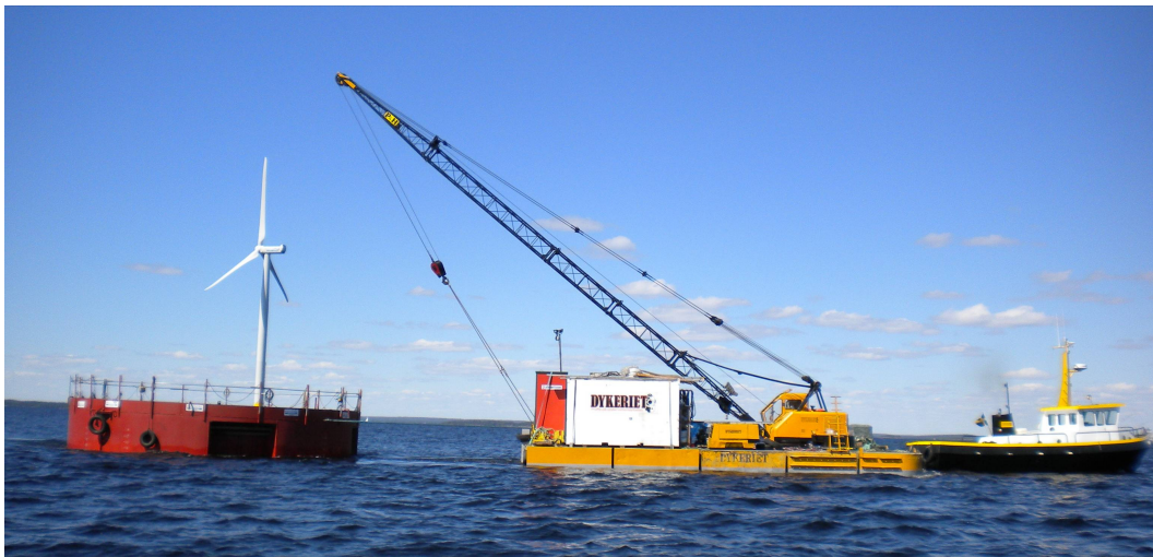
Figur 7.5 Utbogsring av sänkform för fundamentunderhåll
