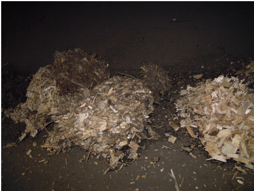
Figur 18. Tjälklumpar som fastnar i bandtransportören för flis.
