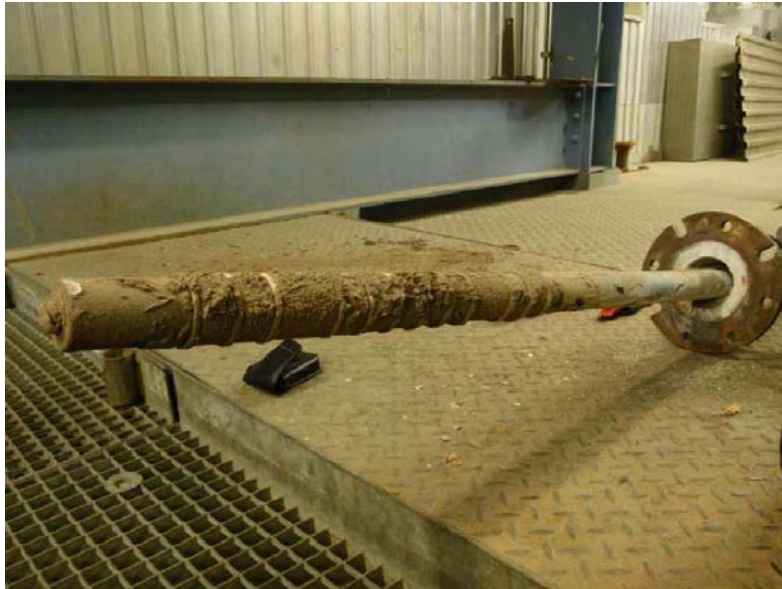
Figur 27. Högtemperatursond efter 5 veckors exponering.
