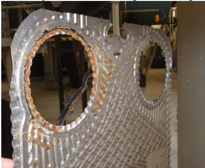
Figur 29. Spaltkorrosion i värmväxlarplåt. Material EN 1.4436 (SS 2343).
