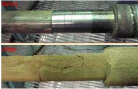
Figur 32. Korrosionsprob där sex olika material kan provas, före och efter ett försök.
