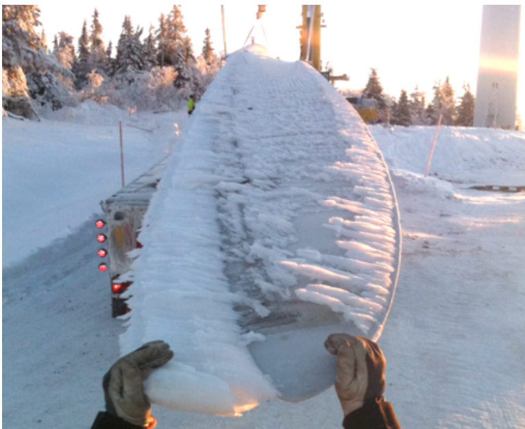
Figur 2: Is på ett rotorblad, som har tagits ner för att demontera ett avisningssystem. Bilden på framsidan visar manuellt montage av avisningsfolie.
