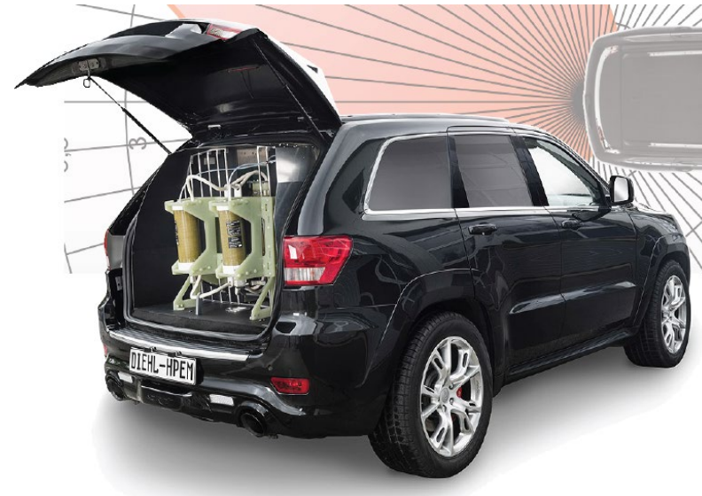
Fordonsburen utrustning för att stoppa bilar genom att bestråla elektroniken.
