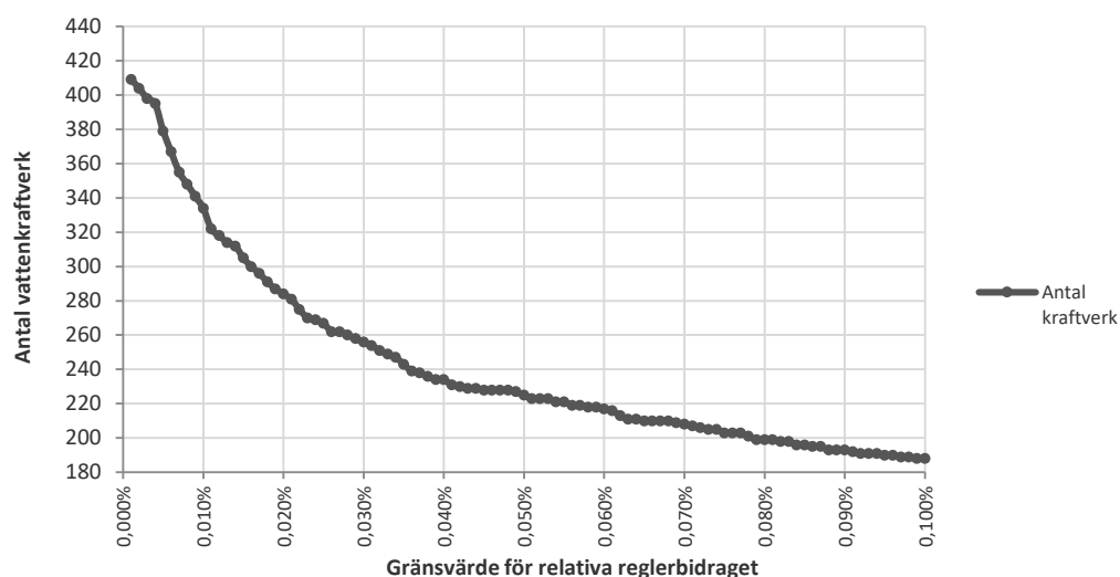
Figur 8: Antal vattenkraftverk vid olika gränsvärden för det relativa reglerbidraget (gränsvärdesintervall 0,001 procent–0,1 procentprocent, år 2009–2014)
