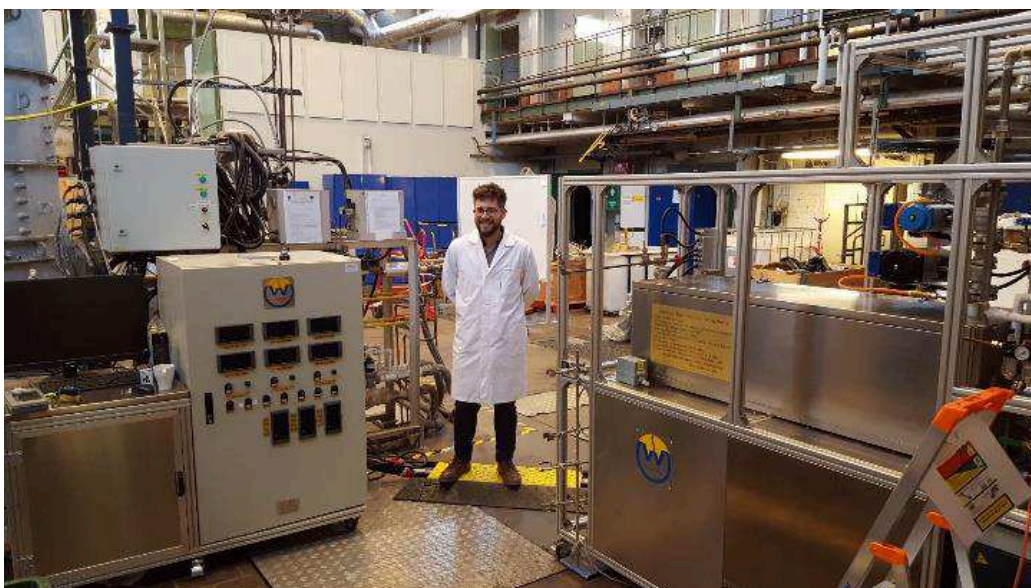
Figur 1: Panagiotis Evangelopoulos i centrum med skruvreaktor till höger i bildoch kontrollsystem till vänster.
