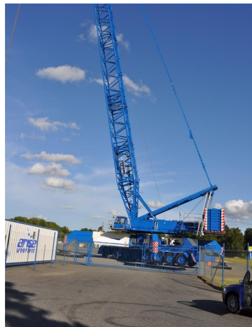
Figur 3: Arise hjulkran av modell Liebherr LG1750.
