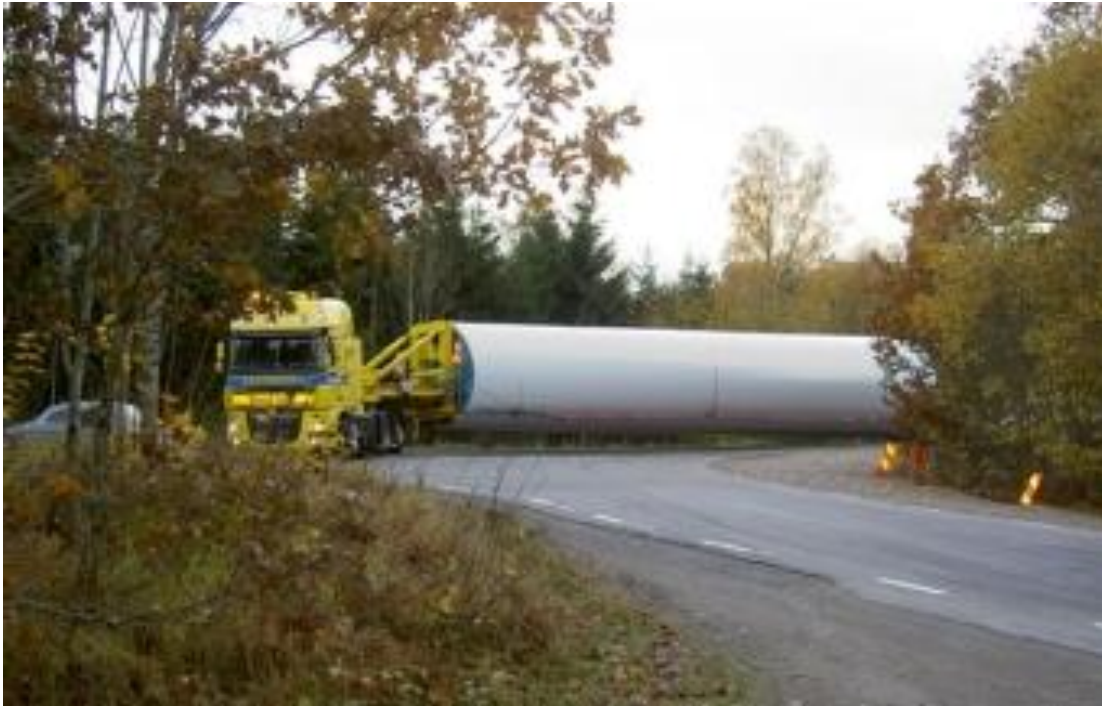
Figur 6: Transport av torn till en Vestas V90.
