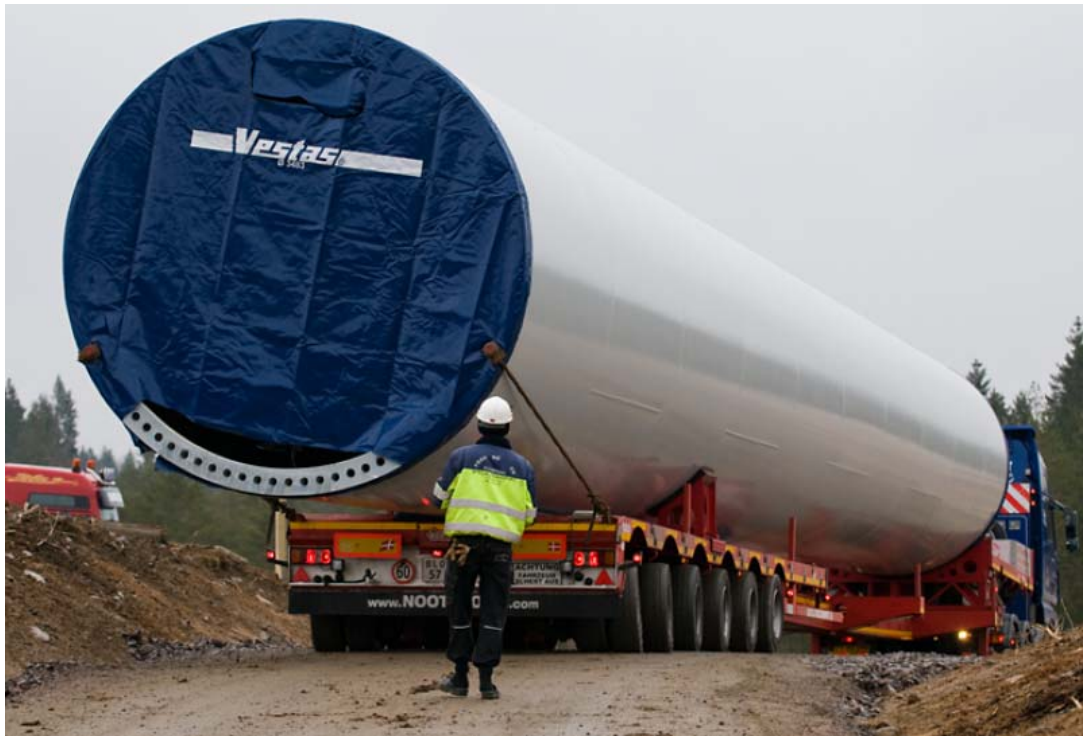
Bild 15: Transport av torndel. Trailers styrs av den gående med joy stick.
