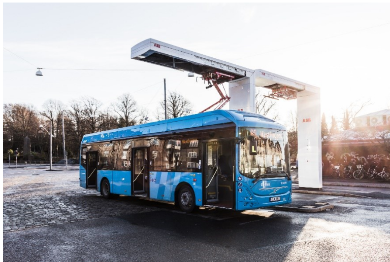
Figur 1: En batteribuss från Västtrafik med vändhållplatsladdning. (Foto: Peter Dädeby)
