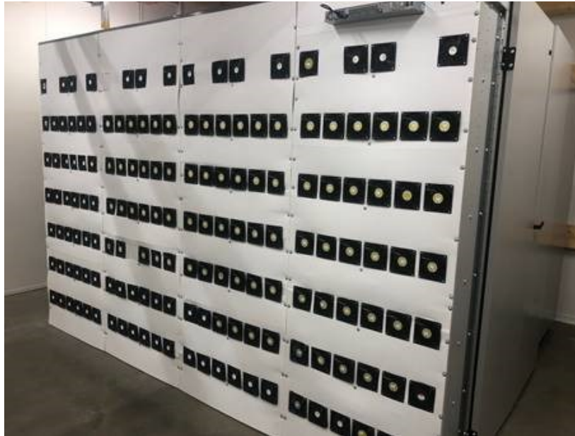
Figur 3 Datacenteranläggning för kryptovaluta med ASIC-rigg. Bild: RISE 25
