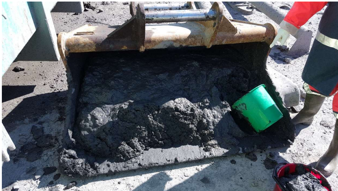
Figur 1. Muddring och provtagning av organiskt tenn- och metallförorenat sediment från Arendalshamen i Göteborg. Foto: Anna Norén
