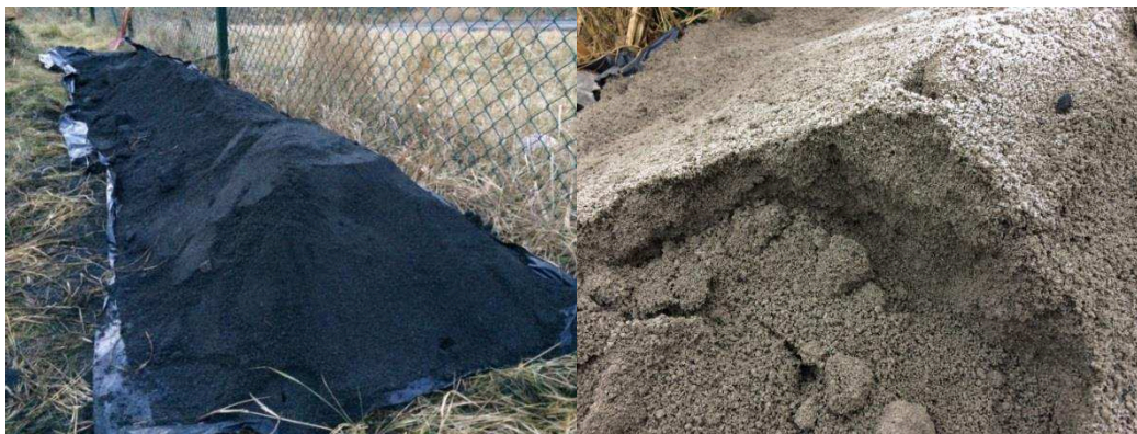
Figur 9. T.v. Direkt efter försök 1 placerades askan i en stuka för att undersöka dess karaktäristik vid lagring. T.h. Aska från försök 1 efter tre veckors lagringstid. Färgen på askan har återgått till den ursprungliga brun/grå.
