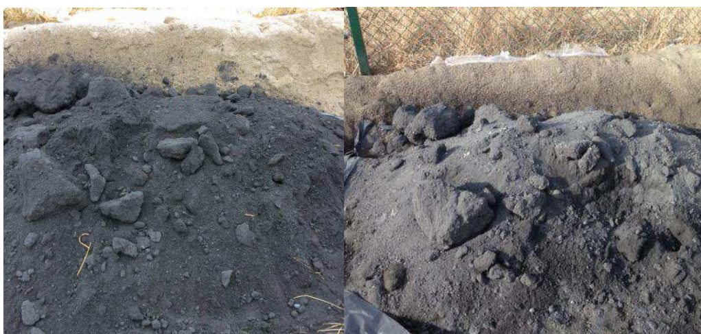
Figur 13. T.v. Aska från försök 2 direkt efter urtag. T.h. askhögen efter 8 veckors lagring. I bakgrunden syns askan från försök 1.
