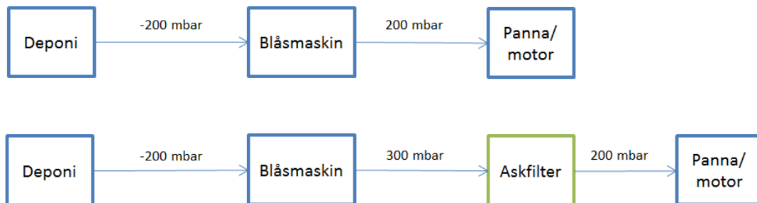
Figur 15. Schematisk bild över systemtrycket med respektive utan askfilter för rening av H 2 S.
